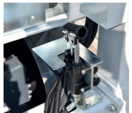
Manuelle Notabsenkung der Stützen
