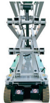
Neues Design des Fahrgestelles, das eine einfache Reinigung ermöglicht und einen besseren Schutz der Komponenten gewährleistet
