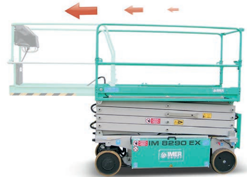
Manuelle Plattformverlängerung um 1.3 m
