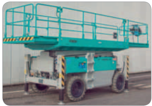
Grosse Arbeitsplattform mit einer Gesamtlänge von 6.8 m (mit doppelt asymmetrische Plattformverlängerung).
